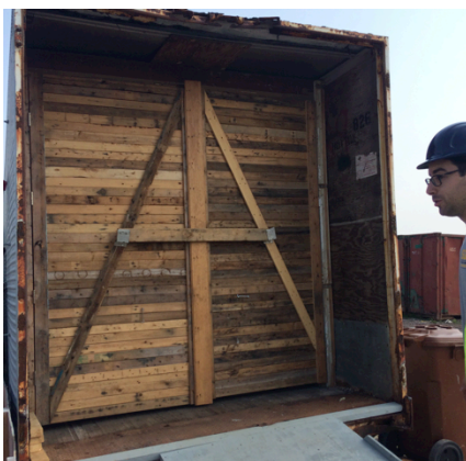
Figure 5 Modification des remorques avec des matériaux récupérés
