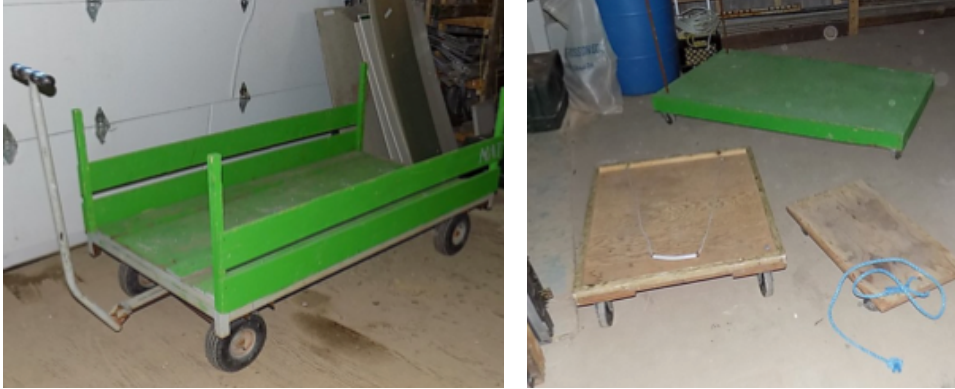
Figure 15 Charriots pour le transport des matériaux
