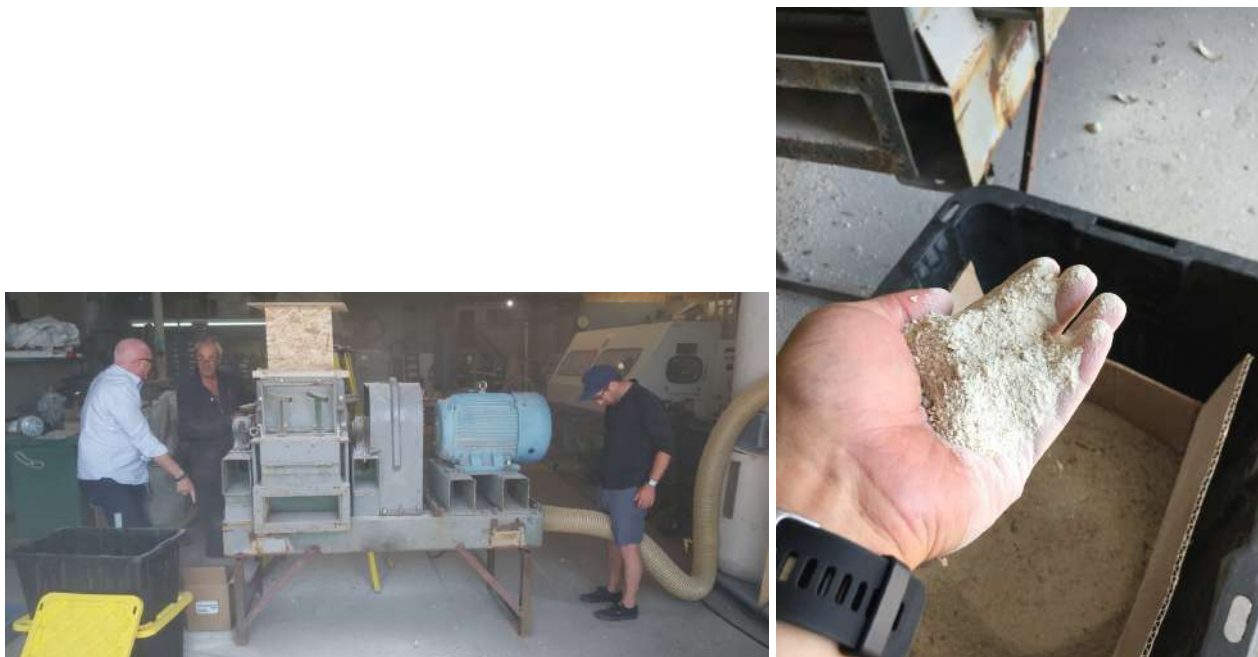
Figure 14. Broyeur à marteaux (Machinerie.ca) - coquilles broyées
