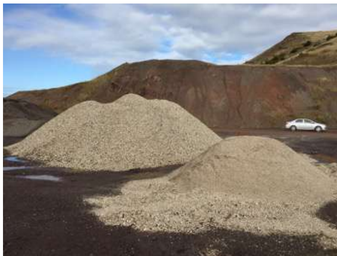
Figure 18. Coquilles broyées à 3/4 po (en arrière) et à 1/4 po (devant)
