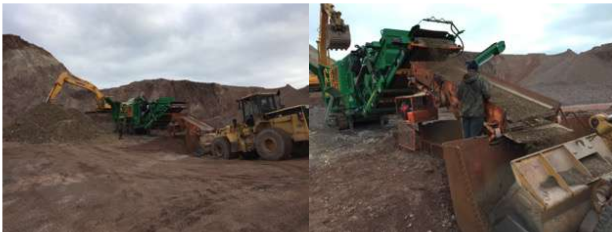
Figure 7. Concassage et tamisage des coquilles du CGMR
