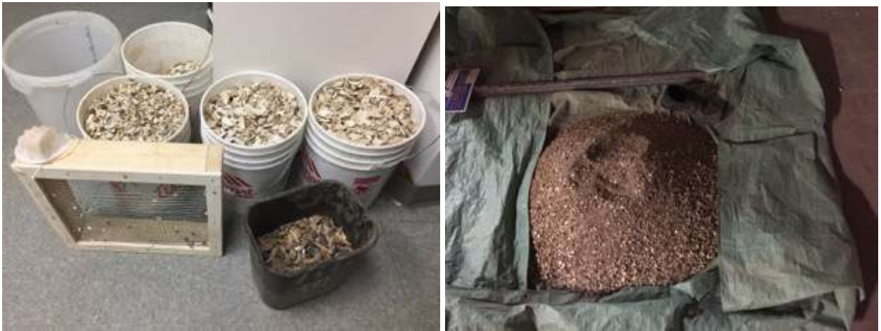
Figure 19. Tamisage manuel des coquilles - présence de contaminants
