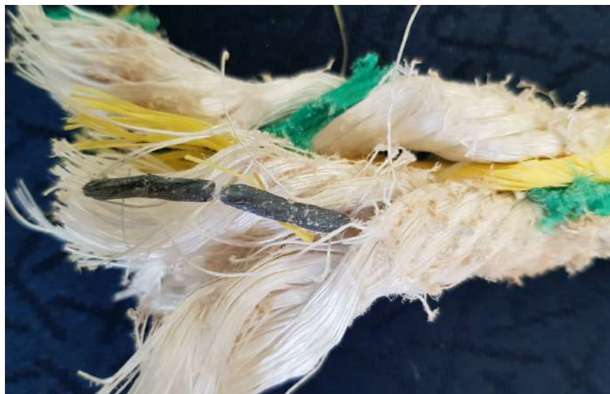
Figure 12. Cordage mécaniquement muni de plomb
