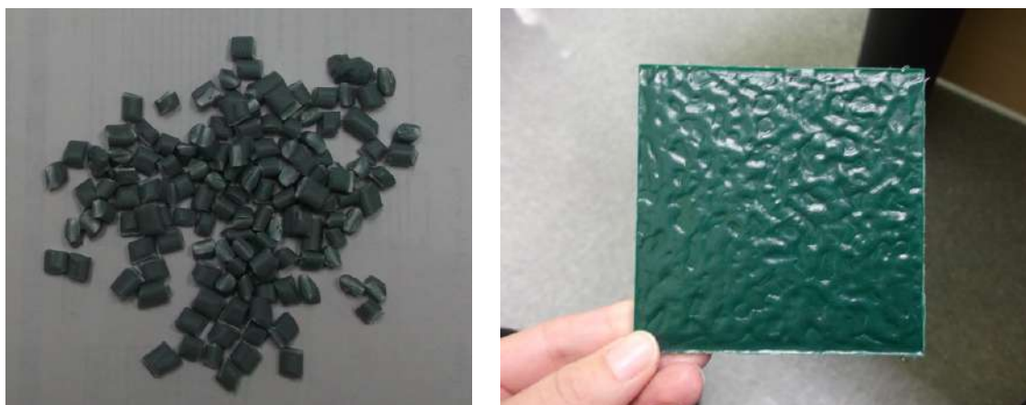
Figure 14. Plastique fait à partir de cordages
