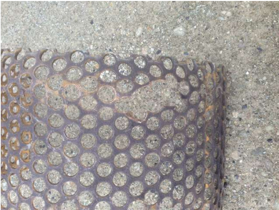
Figure 15. Tamis perforés suite au broyage des BAPC
