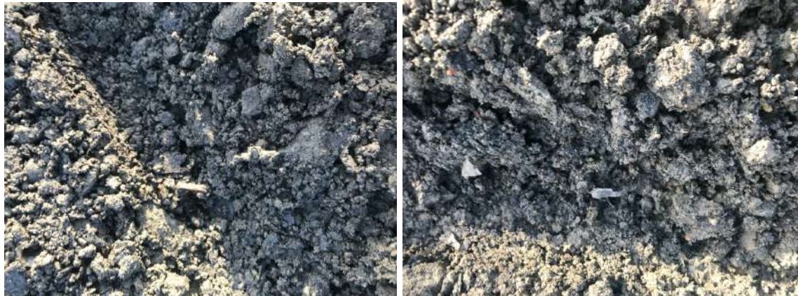
Figure 5.9. Mélange in-situ à 15% de BAPC, présence minime de déchets
