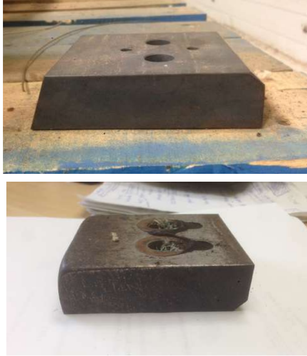
Figure 17. Couteaux avant et après broyage des BAPC
