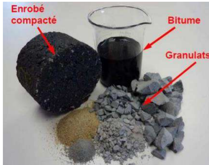
Figure 3.1. Composition enrobé compacté (MTQ, 2016)
