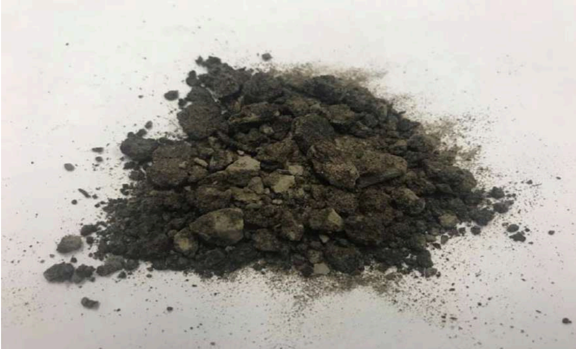
Figure 4. Mélange de sable silteux et de BAPC (30 %) (Nuth, 2019)
