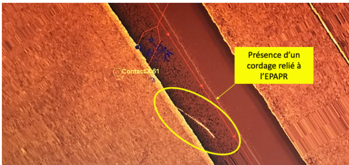
Figure 26. Image provenant du logiciel Sonarwizz utilisé par l'équipe pour le projet, où l'on distingue un cordage dans la colonne d'eau.
