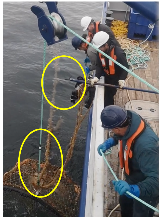
Figure 44. Arrivée à la surface du harpon accroché à la cage avec le ROV empêtré dans le cordage de l'EPAPR.
