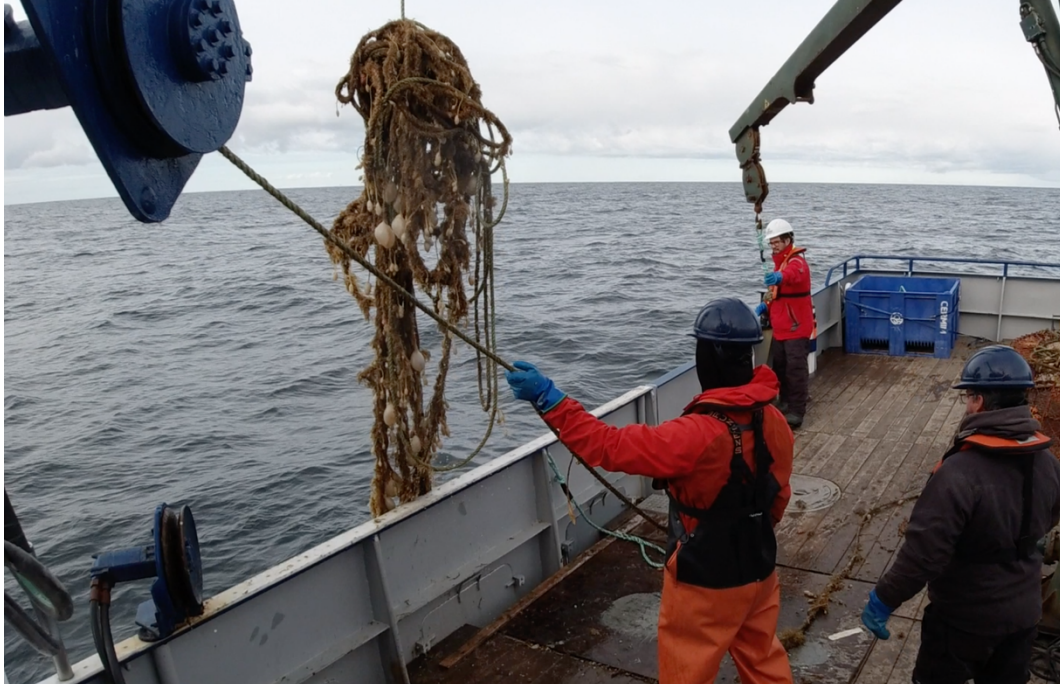
Figure 42. Présence d'un amas de cordage sur l'EPAPR limitant l'utilisation du treuil.
