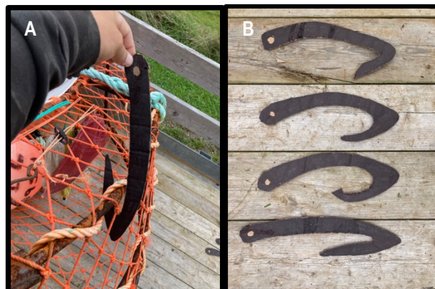
Figure 31. A) et B) Phases de design du crochet et test.
