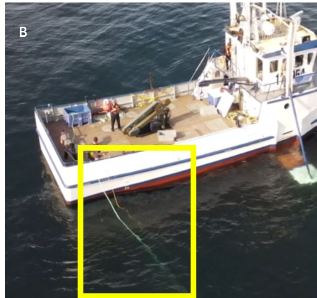
Figure 34. A) Plongée du ROV à l'arrière du navire – et B) Disposition des deux câbles reliés au ROV sur le côté tribord du Francis-Éric.
