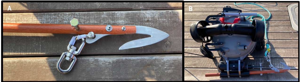
Figure 30. A) et B) Harpon développé par l'équipe du projet LORÉVA- IM pour accrocher les EPAPR par ROV.
