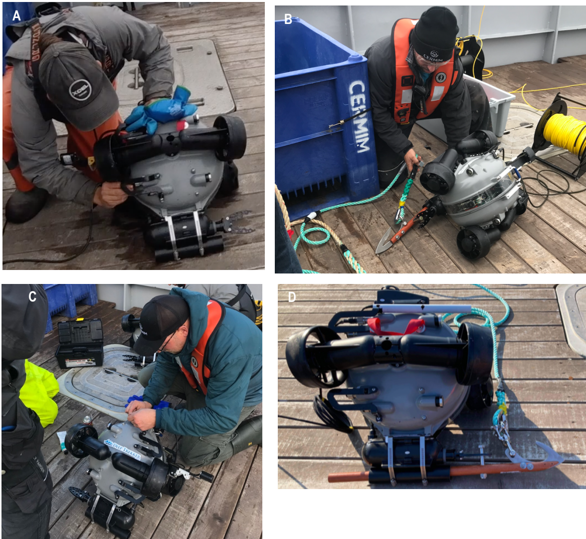
Figure 32. A) Le technicien assure l'étanchéité du véhicule - B) Le responsable technique accroche le harpon au ROV - C) Le capitaine s'assure que tout est prêt pour la manœuvre - et D) Le ROV est armé avec son harpon de récupération.
