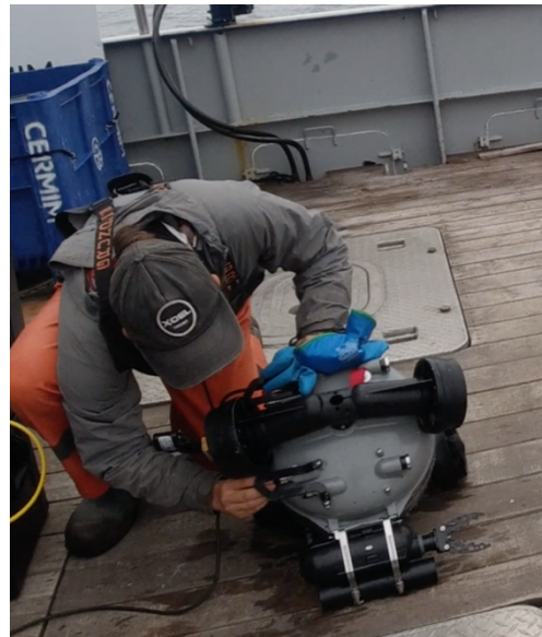
Figure 9. ROV de catégorie observation, de la marque Deeptracker et de modèle DTX2.
