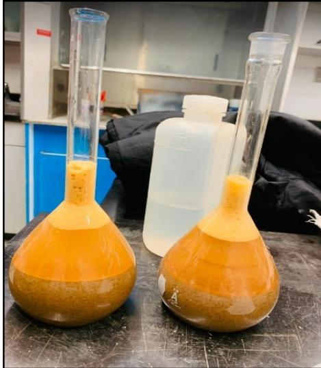
**Figure 3. 5 :** Pycnomètres remplis des échantillons de sable et d'eau
