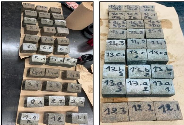
**Figure 3. 18:** Les cubes de mortiers des différentes formulations
