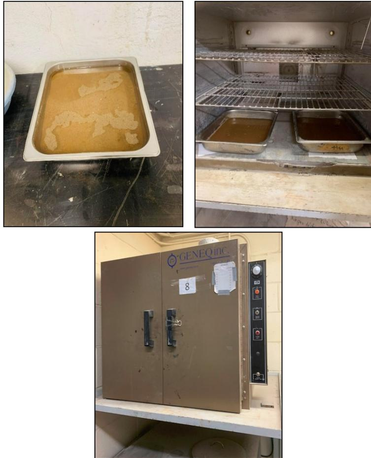
**Figure 3. 14 :** Lavage du sable pendant 72h dans l’eau et étuvage du sable de dragage
