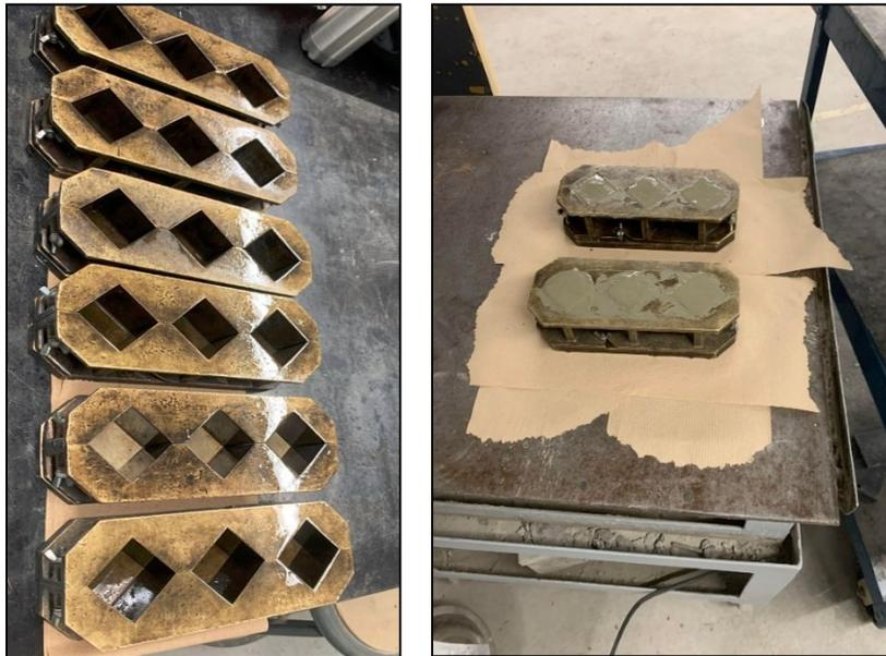
**Figure 3. 7 :** Mise en place des pâtes dans les moules en cubes et compactage
