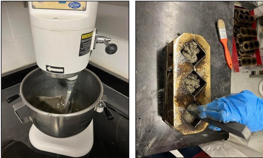
**Figure 3. 16 :** Malaxage et compactage des mortiers
