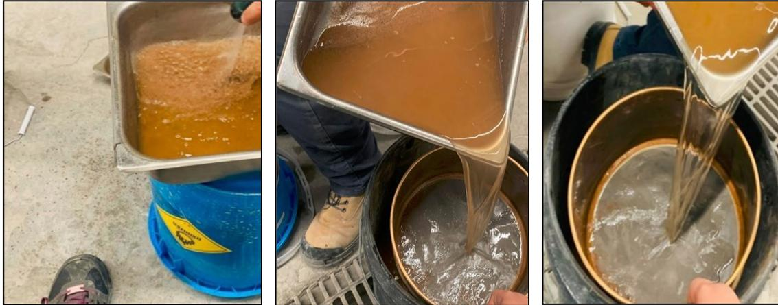
**Figure 3. 13** : Lavage au jet d'eau du sable de dragage
