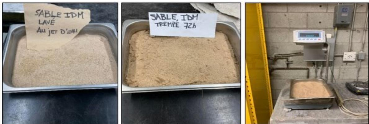
**Figure 3. 15 :** Sable de dragage des IDM
