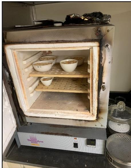
**Figure 3. 2:** Calcination de carapaces de crustacés
