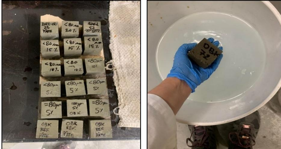
Figure 3. 8 : Placement des pâtes formulées dans la chaux puis leur stockage dans la chambre humide
